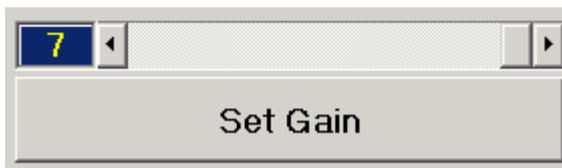
11. **Set Gain**: 調整 Reader 接收 TAG 訊號的功率，此功能可用來控制(縮短)reader 的讀取距離。Level 7 為預設值，可以讀取的距離最遠；Level 1 可以讀取的距離最近。
