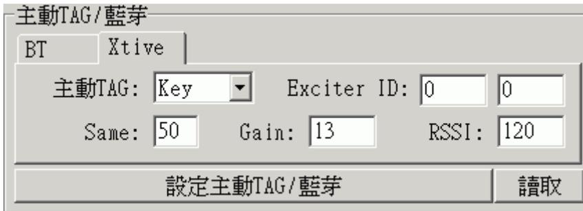
**主動式TAG**：設定主動式RFID tag讀取方式。
