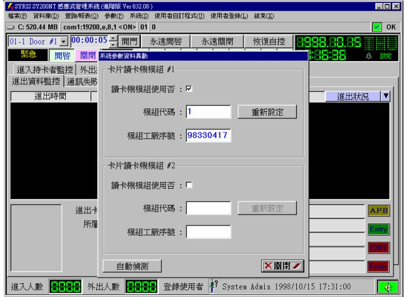
图 5-3 连接至计算机之卡片阅读器设定
