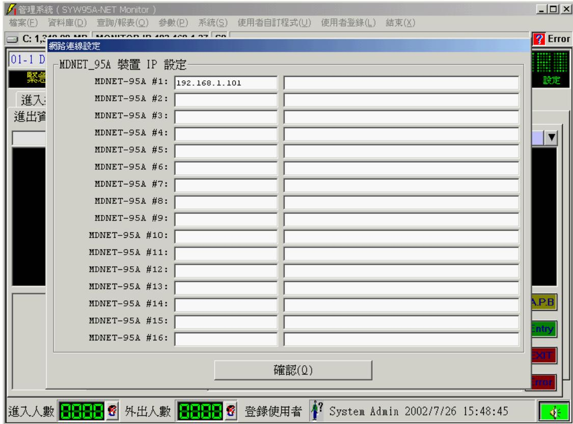
四、在右邊欄位輸入控制器的 ID (ID 之間要用逗號分隔；一台 NET 可接 80 台控制器；整個系統最多 99 台控制器)：
