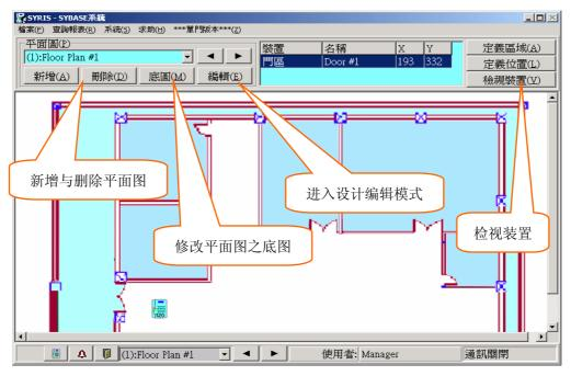
新增删除编辑平面图,并可设定平面图之底图。可按编辑钮进入设计编辑模式,新增控制器 与图面连结等装置。
