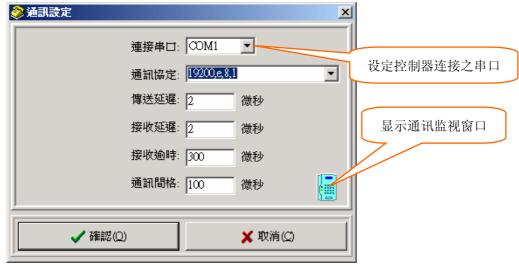
设定通讯连接之参数,通讯间格为控制器间轮流读取数据之间隔时间。
